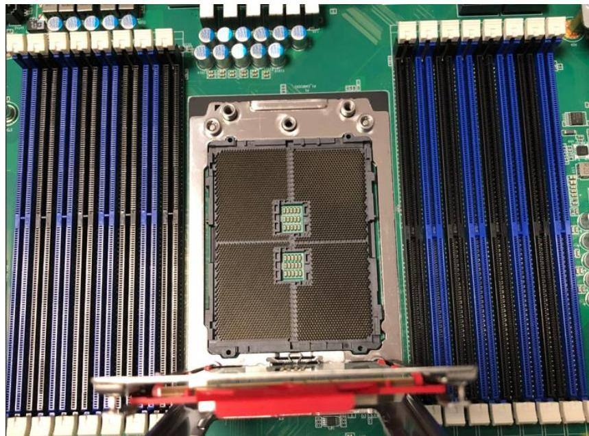
7. 将安装好CPU的支架卡住
